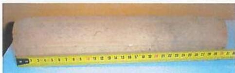
Photo 47 : Drain de dernier ordre ou petit drain (30,5 cm de long pour 4 cm intérieur) trouvé dans la pâture pourrie.
